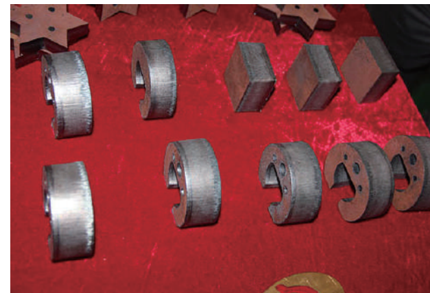
万瓦激光厚板切割样品
